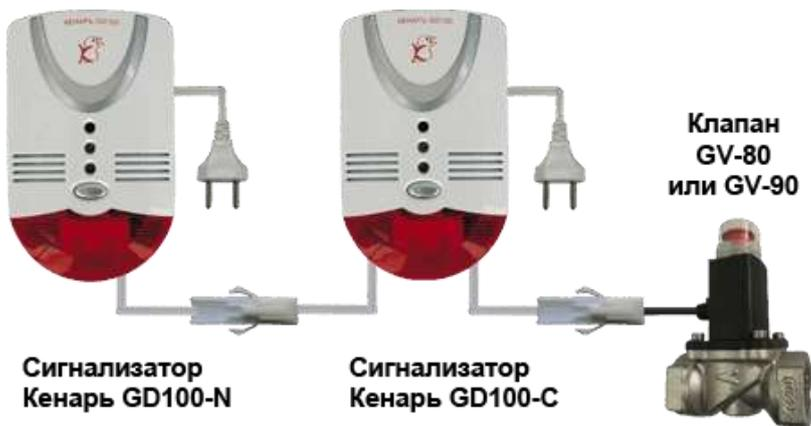
Предназначена для автоматического непрерывного контроля объемной доли метана в воздухе (концентрации) и объемной доли оксида углерода в воздухе (концентрации), выдачи сигнализации и перекрытия газовой магистрали при превышении установленного порогового значения любым из контролируемых газов.
